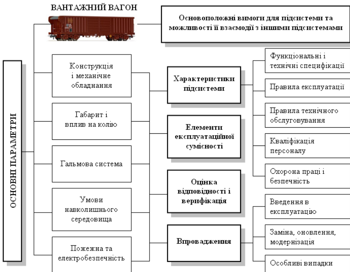
Рис. 2 – Структура ТСІ для підсистеми «Вантажні вагони»
